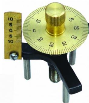
**PHY-00684 SPHEROMETER DOUBLE DISC**
