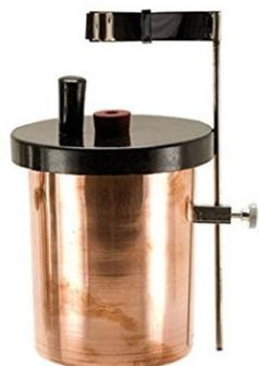
**PHY-00121 CALORIMETER COPPER WITH WOODEN BOX & STIRRER**
